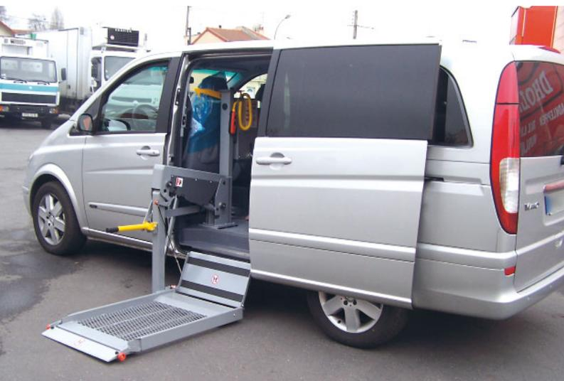
La plataforma DH-PH1 es un elevador **con un brazo de elevación recto**, adecuada para montarla detrás de las puertas traseras o laterales en una amplia gama de monovolúmenes, minibuses y ambulancias.
